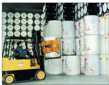
Lagerung konditionierter radioaktiver Abfälle in Stahlfässern.
