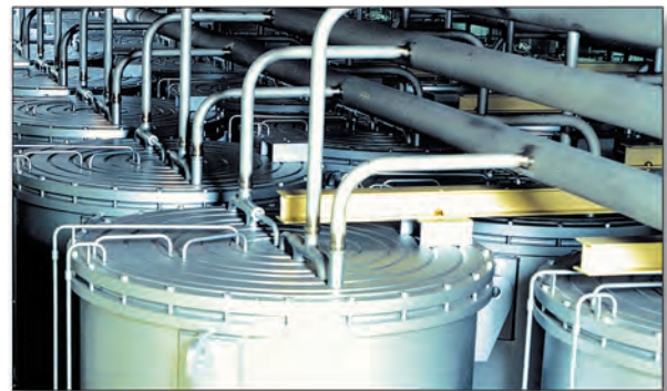
Zentrifugenkaskaden in Rokkasho-mura, Japan.
