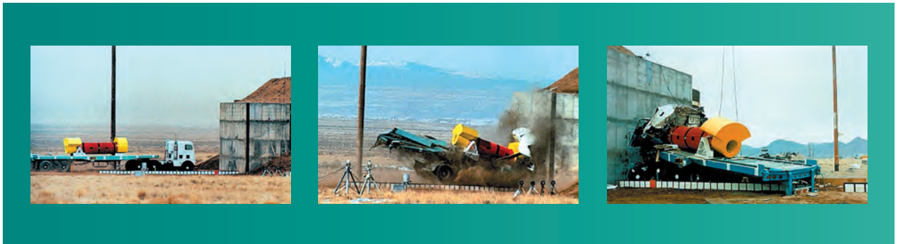
Erprobung eines Brennelemente-Transportbehälters.
