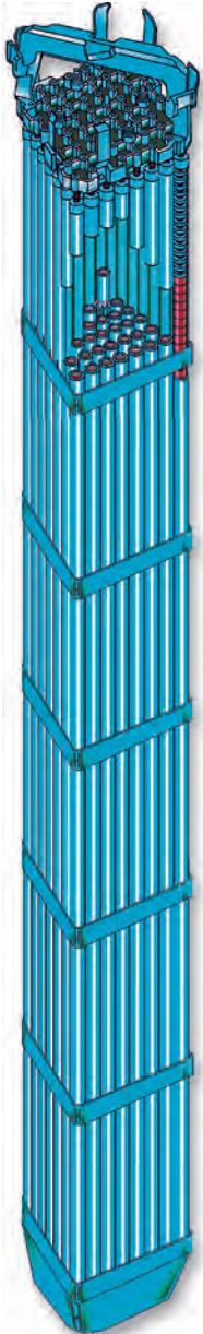
Typisches SWR-Brennelement: Etwa 4 m lang und auf jeder Seite rd. 15 cm breit; es wiegt ungefähr 300 kg.
