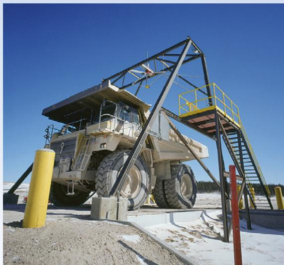
Système d'analyse des chargements d'extraits miniers pour classifier le minerai et isoler les stériles miniers potentiellement problématiques pour une mise en dépôt appropriée, lac McClean.
