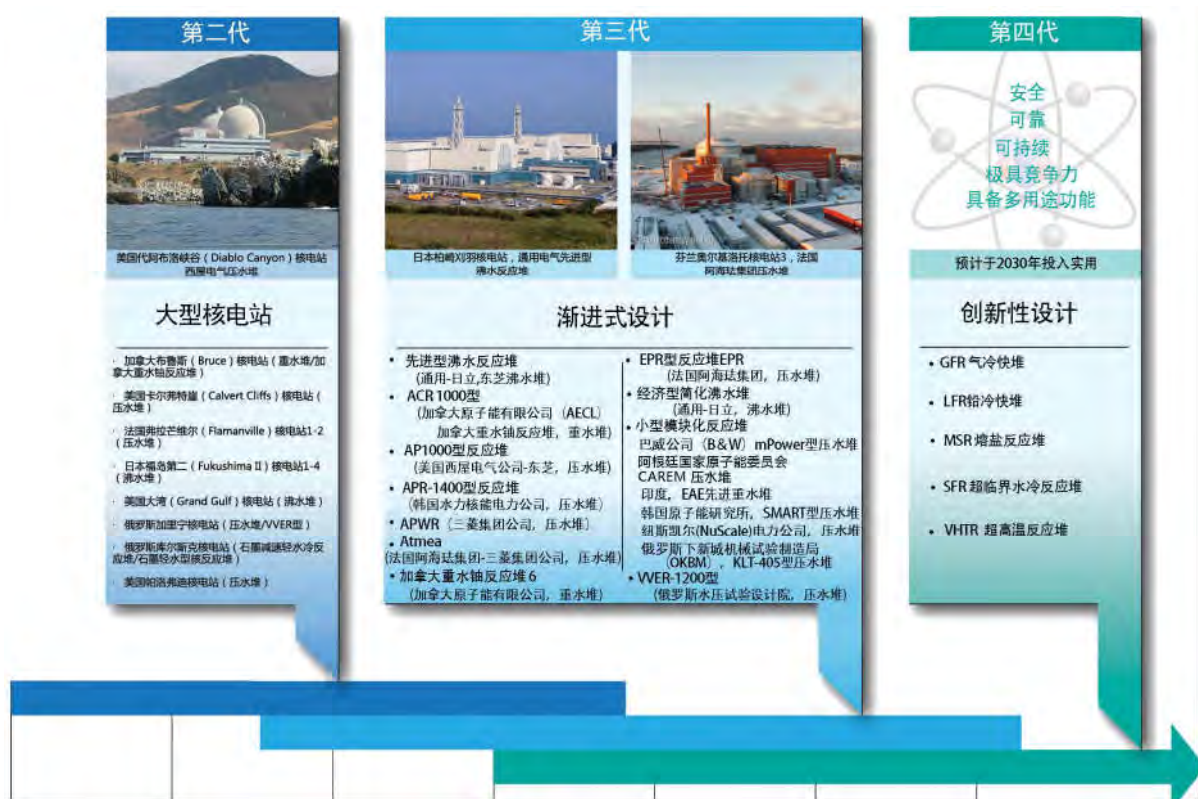
图 7：核裂变反应堆技术的发展演变
