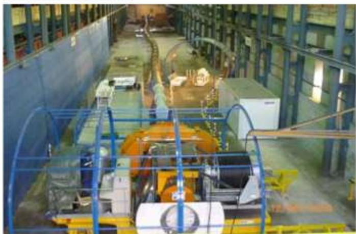
図3b:フランスで実施された模擬処分坑道を使用した高レベル廃棄物の回収試験(ESDRED programme, 2008)
